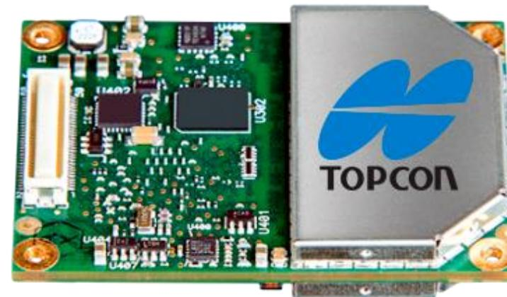
Сверхкомпактный приемник способен обеспечить получение данных позиционирования в любых условиях: начиная субметровым DGPS-позиционированием, заканчивая позиционированием в субсантиметровом PPK-режиме. Плата B111 обеспечивает надежное получение данных в двухчастотном L1 / L2 режиме со спутниковых систем GPS/ГЛОНАСС/BeiDou.
